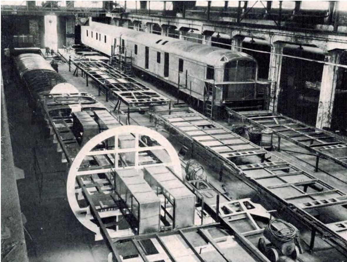
Hansa Waggonbau Montagehalle (1950/51) mit Montage von Paketpostwagen<sup>560</sup>
