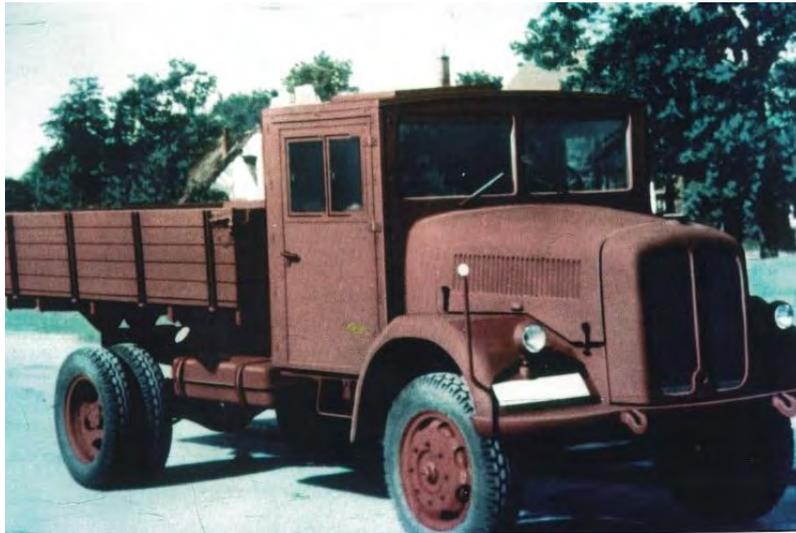
**Benzingetriebene B 3000 mit hölzerner Fahrerkabine, die auch schon an Wehrmachtsfahrzeugen eingebaut wurde. Das Fahrzeug wurde in Sebaldsbrück produziert**
