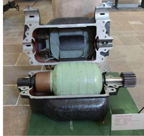
**Straßenbahn (1899) und Elektromotor für einen Straßenbahntriebwagen der UEG (1896)<sup>262</sup>**
